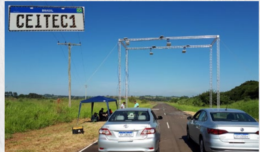
Ensaio da solução CEITEC para identificação eletrônica incorporada na placa veicular
